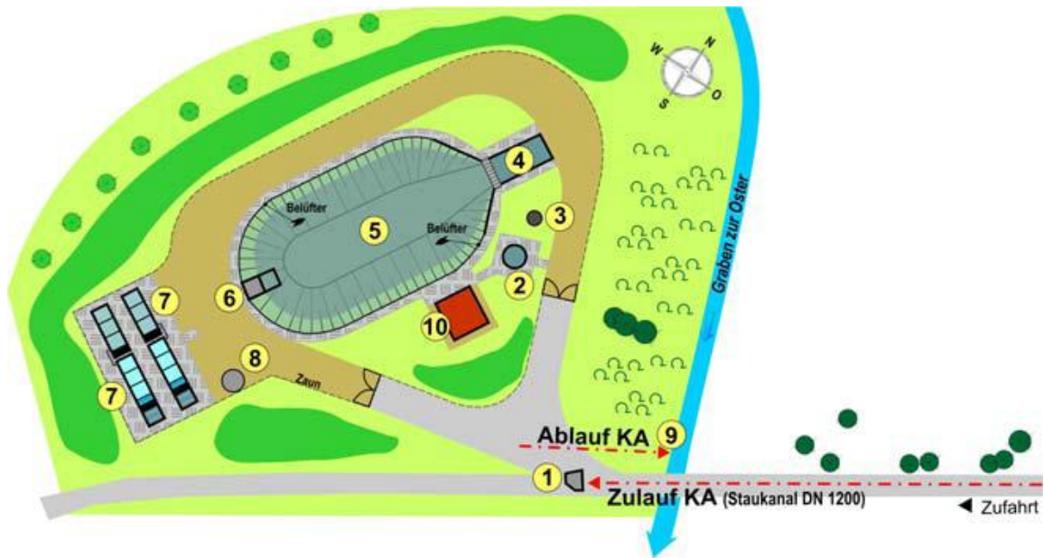
shematski prikaz gornjeg bio-pročistača za 600 ES
